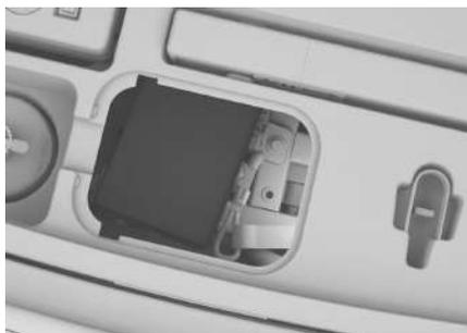
Доступ к предохранителям можно получить, сняв отделение для хранения.
