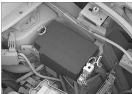
Чтобы открыть блок реле и предохранителей, нажмите на два фиксатора на крышке блока, а затем потяните крышку вверх.
