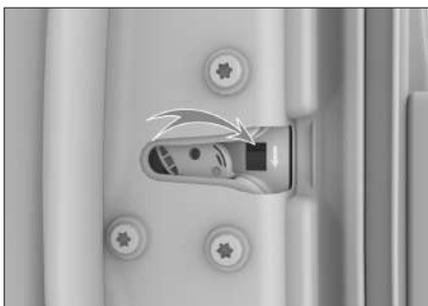
Вставьте механический ключ или плоскую отвертку в паз аварийного замка, поверните его в крайнее нижнее положение, а затем закройте дверь, и она заблокируется.
