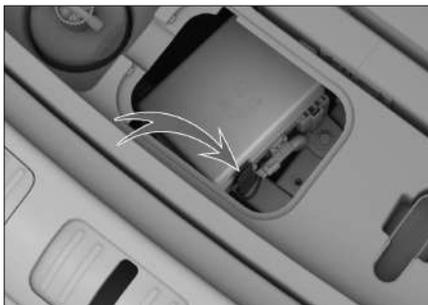
Все жгуты проводов точки аварийного отключения обмотаны лентой, и на них наклеена маркировка линии аварийного отключения.
