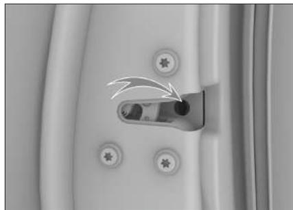
Вставьте механический ключ или плоскую отвертку в паз аварийного замка и поверните его по направлению к внешней стороне двери. После извлечения инструмента аварийный замок автоматически вернется в исходное положение, после чего закройте дверь, и она заблокируется.
